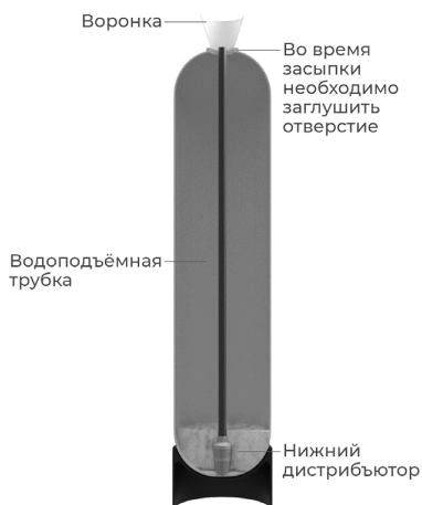
Заполнение фильтра материалом
